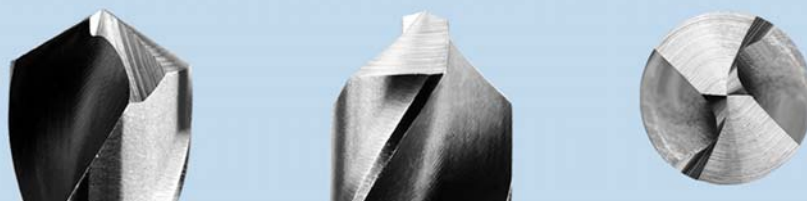
PREPARAZIONE DELLA PUNTA PER L'AFFILATURA PREPARING FOR DRILL GRINDING
